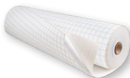
**■** Uitgezette polyethyleen kleeffilm voor de binnenbescherming van autodeuren. Water-, vocht- en stofbestendig. Goede geluidsisolatie. Hittebestendig tot 60°C. **Lijm:** Acrylaat.
