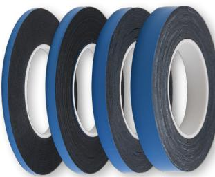
**UV** Dubbelzijdige kleefband met hoge kleefkracht in PE voor het bevestigen van emblemen en accessoires, zowel binnen als buiten. Bestand tegen oplosmiddelen, UV-straling en temperaturen tot 120°C. **Kleefstof:** acrylaat. température de 120°C. **Adhésif:** acrylique.
