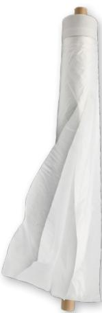
Film pour le masquage et la protection des cabines de peinture de carrosserie. Réalisé en collant un ruban spécial en papier de riz et quatre feuilles de PEHD préalablement pliées et pourvues d'une prédécoupe sur la partie supérieure.
