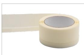
Zelfklevende tape voor het afplakken van raamrubbers bij het sputten zonder het glas te demonteren. De tape bestaat uit een kleefstrook (h. 40 mm) en een voorgevormde, soepele polyesterfilm (h. 10 mm) voor gemakkelijke toepassing in bochten. Hittebestendig tot 80°C gedurende 30 minuten.
