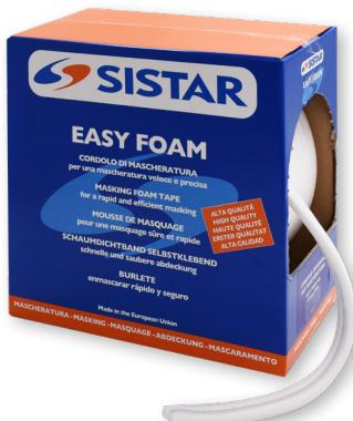
**■** Zelfklevende schuimtape voor het afplakken van openingen tussen portieren, motorkap en kofferdeksel, om te voorkomen dat verf in de kieren binnendringt. In tegenstelling tot klassieke maskerschuimen wordt deze tape direct aan de binnenzijde van bewegende delen gekleefd en kan ze naar wens worden aangepast. Hittebestendig tot 95°C gedurende 60 minuten.
