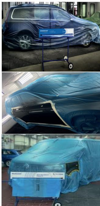
**■** Milieuvriendelijke lakbeschermdolie (met cutter), blauw doorschijnend, statisch en lakopsorpend. Geschikt voor vochtige en droge carrosserie. Voor waterafdunbare lakken en VOC conform laksystemen. 1 zijde vochtopslorpend - Bestendig tot 110°C.
