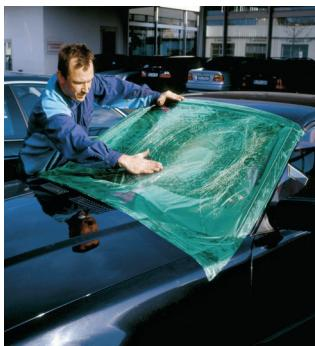
Zelfklevende en sterke PE folie voor de kortstondige bescherming van beschadigde voertuigen, gebroken ruitenvlakken, binnendeur paneel. Geen resten na verwijdering.
