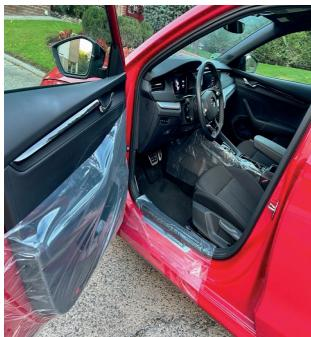
Zelfklevende PE folie voor de kortstondige bescherming van beschadigde voertuigen, gebroken ruitenvlakken en koplampen, deurbekleding, ontbrekend carrosserie elementen. Stevig en zeer bestendig. **Kleur:** transparant.
